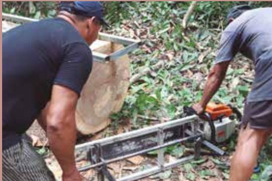
Figura 2 – Instalação da guia (gabarito) para retirada de tábuas na motosserra. O tamanho do sabre da motosserra deve ser longo o suficiente para o diâmetro da tora e a potência da máquina deve ser adequada.
