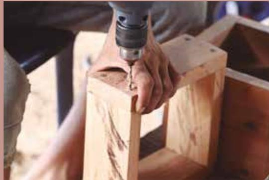
Figura 10 – Para a montagem dos quadros recomenda-se a utilização de parafusos, para uma maior firmeza e durabilidade dos quadros. Para isso, é necessário que sejam colocados ao menos dois parafusos por ângulo fixado.
